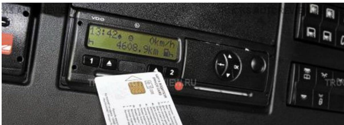
В нашей стране автобусы, у которых в салоне больше 8 мест и грузовики с полной массой свыше 3,5 тонн, обязательно оборудуются тахографами, чтобы обеспечить безопасность для водителя и дорожной ситуации в целом. По закону тахограф должен быть в автомобилях классов N2 и N3, а также M2 и M3. Монтаж контролирующих бортовых устройств осуществляется с учётом специальных регламентирующих документов.
